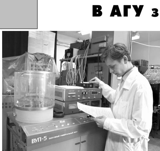
В лаборатории физики металлов и сплавов кафедры экспериментальной физики физико-технического университета. Вакуумный универсальный пост - хороший экспериментальный прибор для получения металлических, интерметаллических и неметаллических пленок, покрытий и
