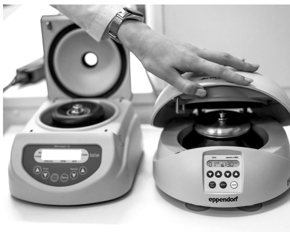
МИКРОЦЕНТРИФУГА. По протоколу выделения ДНК и РНК ученым необходимо центрифугировать вещество, или получить осадок, для этого необходим такой прибор, как микроцентрифуга.
