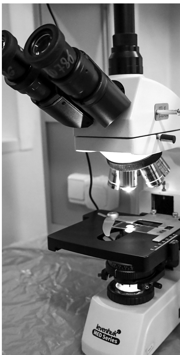
ЦИФРОВОЙ бинокулярный микроскоп со встроенной камерой – прибор, необходимый для исследования объемных биологических объектов.
