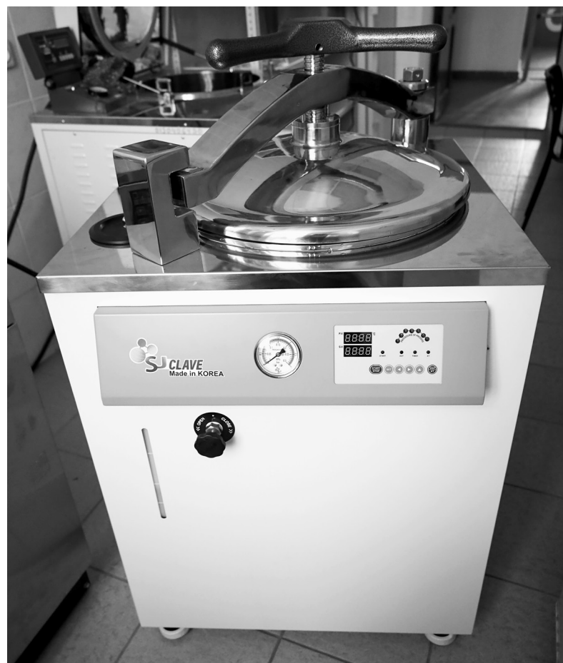
АВТОКЛАВ – аппарат, который предназначен для термообработки продуктов, их стерилизации и консервации. Автоклав позволяет сохранить большую часть полезных составляющих, благодаря высокой температуре все вредные вещества погибают.
